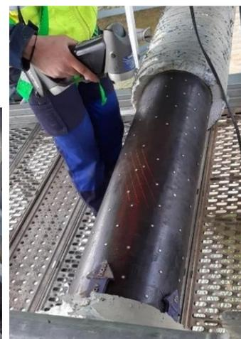
Le diagnostic permet de mettre en évidence les variations d'épaisseur sur des portions caractéristiques de la canalisation étudiée. A l'issue du diagnostic, le bureau d'étude propose une estimation de la durée de vie restante permettant au service de mieux prioriser son plan de renouvellement des canalisations.
